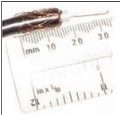
۴- عایق زیر را نیز روکش برداری کنید.
