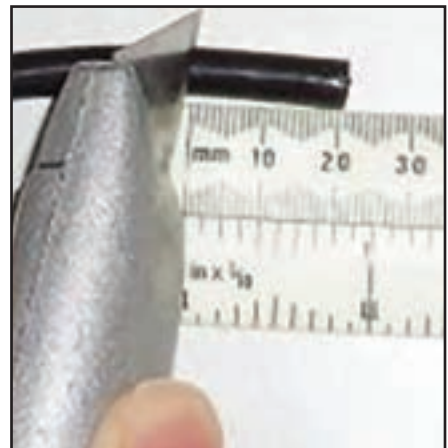
۳- یک قسمت از سیم بافته را کنار زده و عایق زیرین را از میان آن بیرون بکشید.
