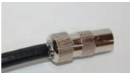
۸- بدنه خارجی را به پیچ مربوطه ببندید و صحت اتصالات با یک اهم متر بررسی کنید. مفتول کابل مسی به سیم افشان نباید اتصال داشته باشد.
