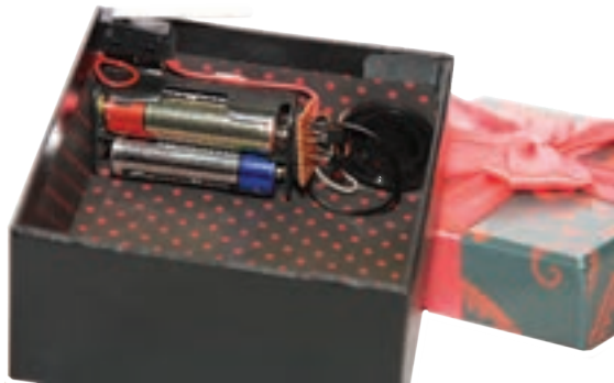
شکل ۲۸-۲- جانمایی مدار پروژه و کلید
