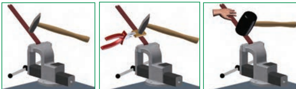
پ - خم کاری با چکش فلزی
