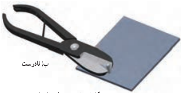
شکل ۸-۱- روش استفاده از قیچی
