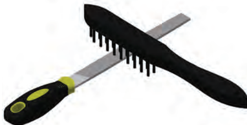
شکل ۱۷-۱- تمیز کردن سوهان با برس سیمی
