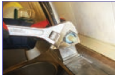
ث- باز کردن پیچ روی مغزی (گلند)
