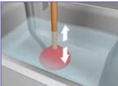
ب - حرکت عمودی لوله بازکن
