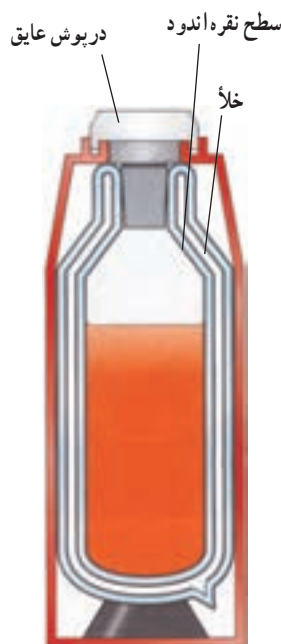
شکل ۱۳- دما بان (فلاسک) خلأ می‌تواند مدت نسبتاً زیادی دمای جسم را تقریباً ثابت نگه دارد.
