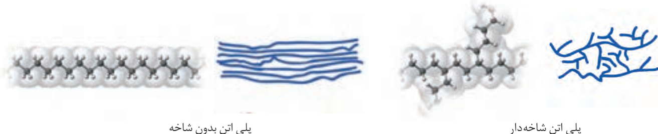
شکل ۸- ساختار دو نوع پلی اتن
