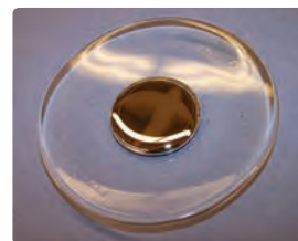
شکل ۲-۹ الف) پخش آب روی سطح شیشه (ب) قطره‌ای شدن جیوه روی سطح شیشه
