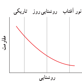
شکل ۲-۲۰ مقاومت بر حسب روشنایی برای یک LDR نوعی
