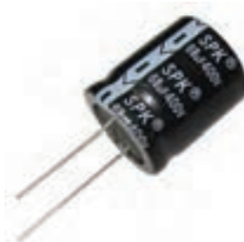
شکل ۱-۴۶ تصویری از یک خازن که روی آن ظرفیت و اختلاف پتانسیل بیشینه قابل تحمل نوشته شده است.
