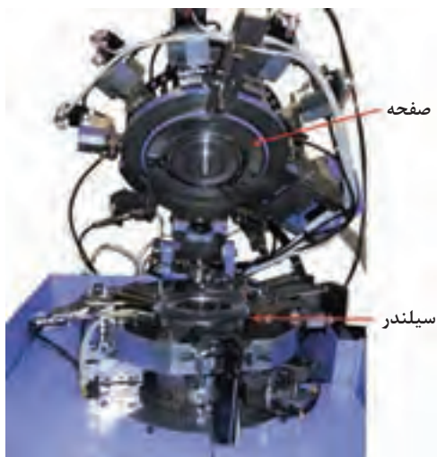
شکل ۹- ماشین جوراب بافی دو رو شامل صفحه و سیلندر
