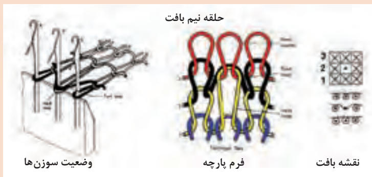
شکل ۱۹- حلقه نیم بافت
