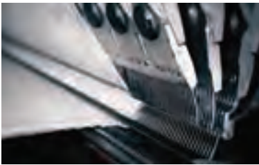
شکل ۱۸- حوله تولید شده با روش حلقوی تاری و وضعیت ابزار بافت در هنگام تولید
