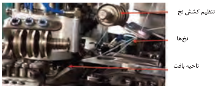
شکل ۱۰- کشش نخ در جوراب بافی
