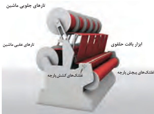
شکل ۵- نمای ماشین کتن ( تریکو بافی )
