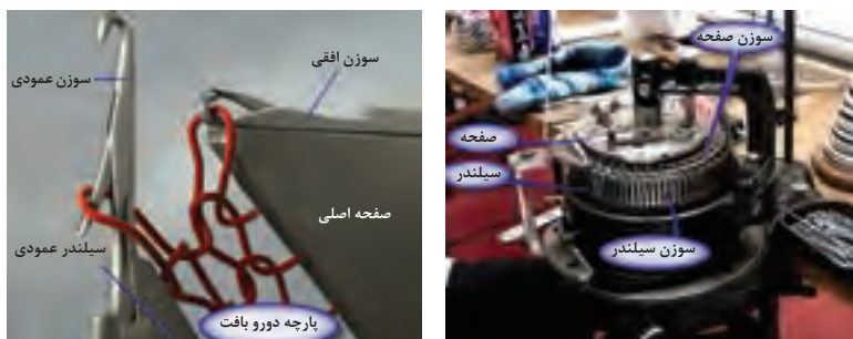
شکل ۱۳- نمای یک ماشین دو سیلندر قدیمی وضعیت سوزن‌ها در حالت دو روبافت
