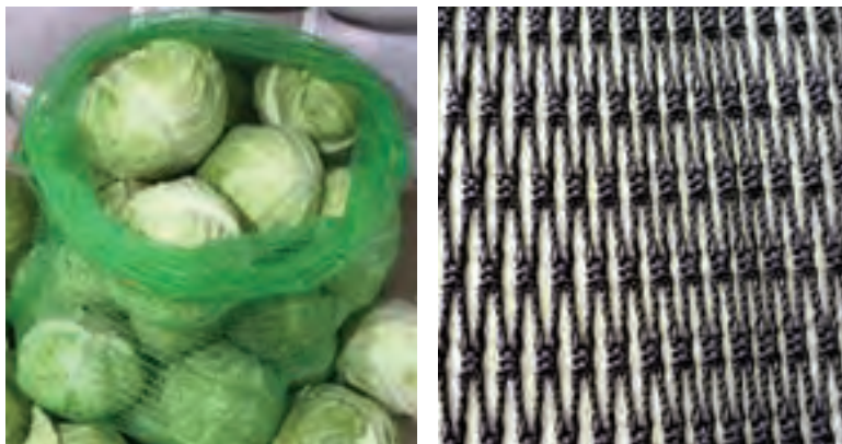
شکل ۱۹- توری راشل بافت ساده توری مورد مصرف در بسته‌بندی میوه‌جات راشل بافت
