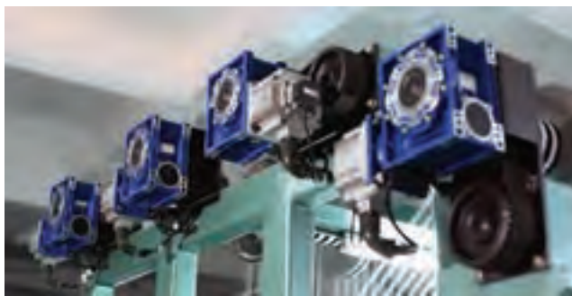
شکل ۷- سیستم کنترل سرعت نوردها برای تغذیه مثبت
