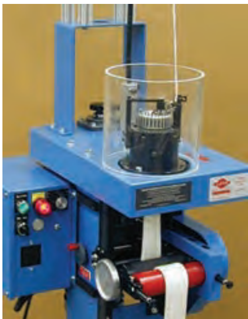
شکل ۶- بافت لوله‌های پارچه‌ای به صورت حلقوی پودی
