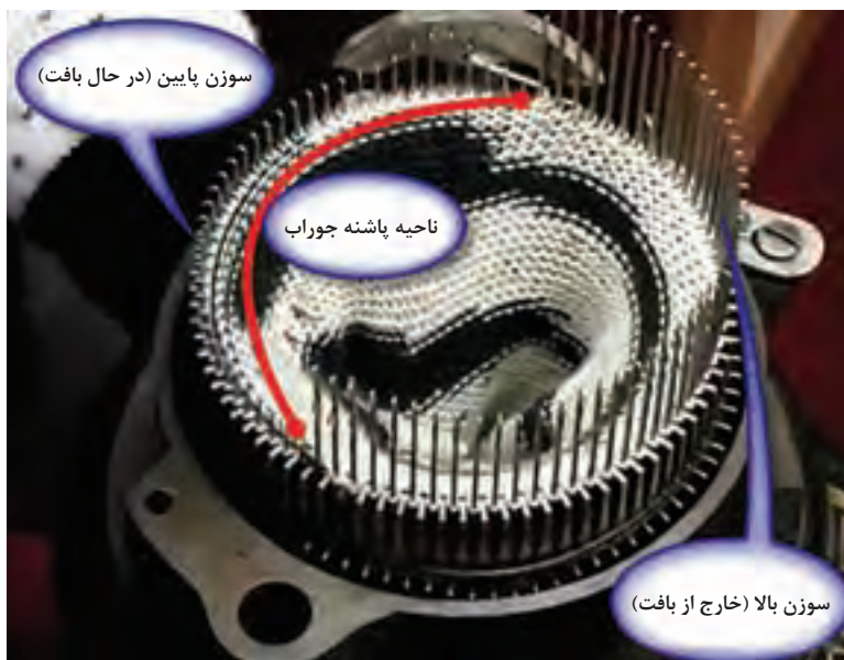
شکل ۱۴- نمایشی از بافت پاشنه جوراب در حالت تک سیلندر
