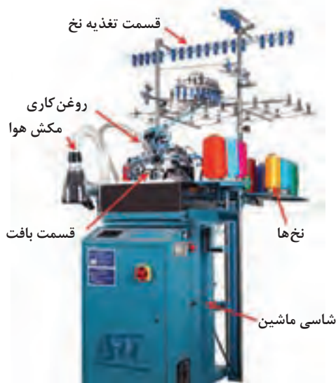
شکل ۸- ماشین‌های جوراب بافی مدرن
