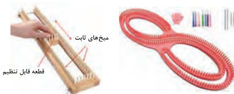
شکل ۴- ابزار بافت پارچه حلقوی پودی با طول قابل تنظیم
