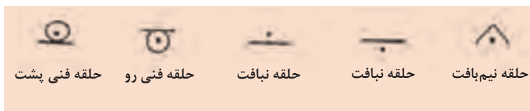
شکل قراردادهای نمایش انواع حلقه‌ها در روش حرکت نخ
