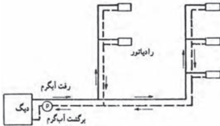
▲ شکل ۳-۹- حرارت مرکزی با آب گرم
