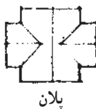
شکل ۲-۴۳- به تأثیر نوع پلان در سایه‌ی نماها توجه کنید.
