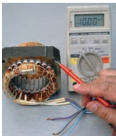
▲ شکل ۱۴-۲ تست اتصال بدنه
