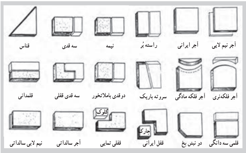
۱۳-۶- اجزای آجر و انواع تراش‌های روی آن
