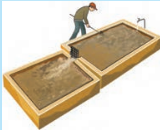
تهیه‌ی آهک شکفته به روش تر (دوغابی)
