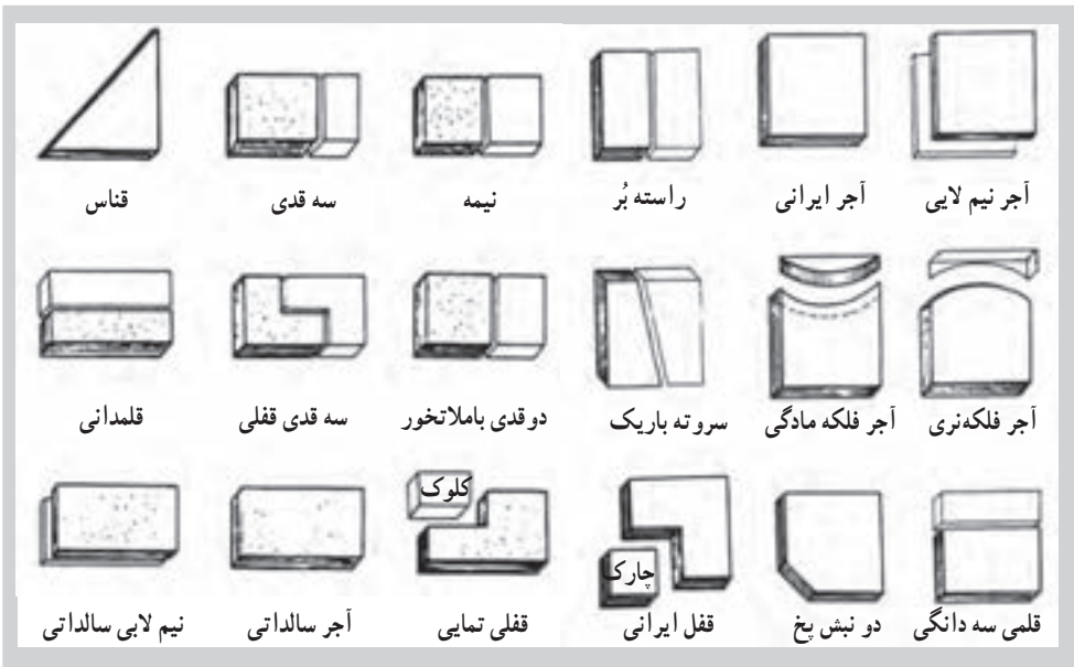
۱۳-۶- اجزای آجر و انواع تراش‌های روی آن
