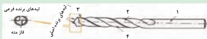
شکل ۵۰ - ۱- اجزای مته مارپیچی
