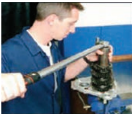
شکل ۱۲-۱ کار با ترک متر قابل تنظیم
