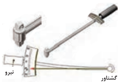
شکل ۱۳-۱ ترک متر عقربه‌ای
