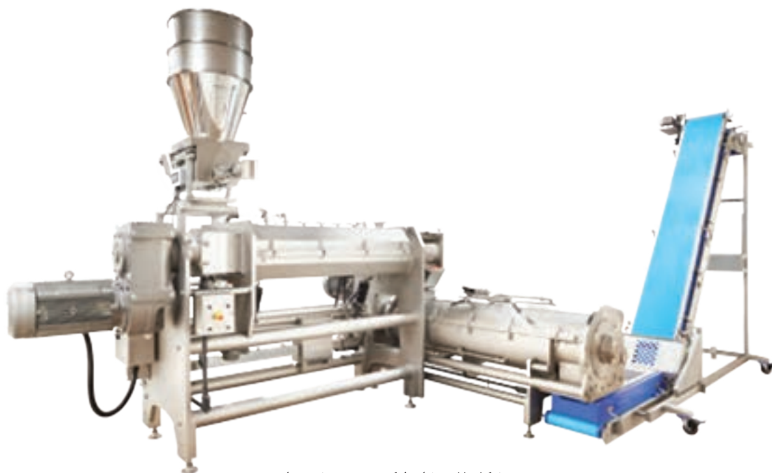
شکل ۷- مخلوط کردن به روش مداوم
