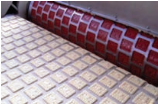
شکل ۷- قالب‌زنی بیسکویت با ماشین قالب‌زن دوار
