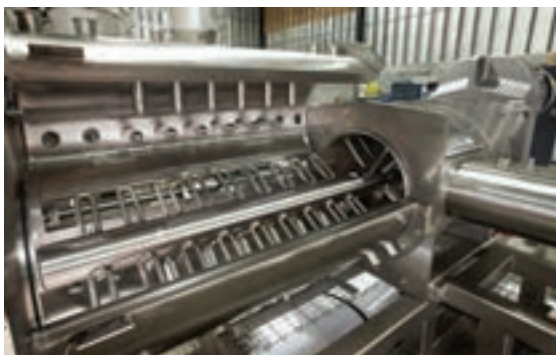
شکل ۴- مخلوط‌کردن بیسکویت به روش مداوم
