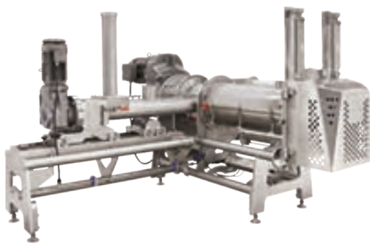
شکل ۴- مخلوط‌کردن بیسکویت به روش مداوم
