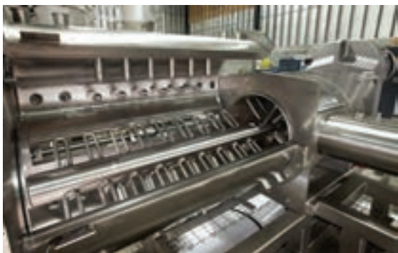
شکل ۴- مخلوط‌کردن بیسکویت به روش مداوم
