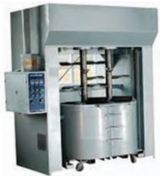
شکل ۲- مخلوط‌کن عمودی با مخزن قابل جدا شدن
