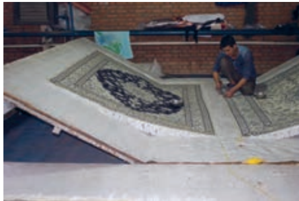
تصویر ۵- مراحل سرراست کنی (دارکشی) لولایی ▲
