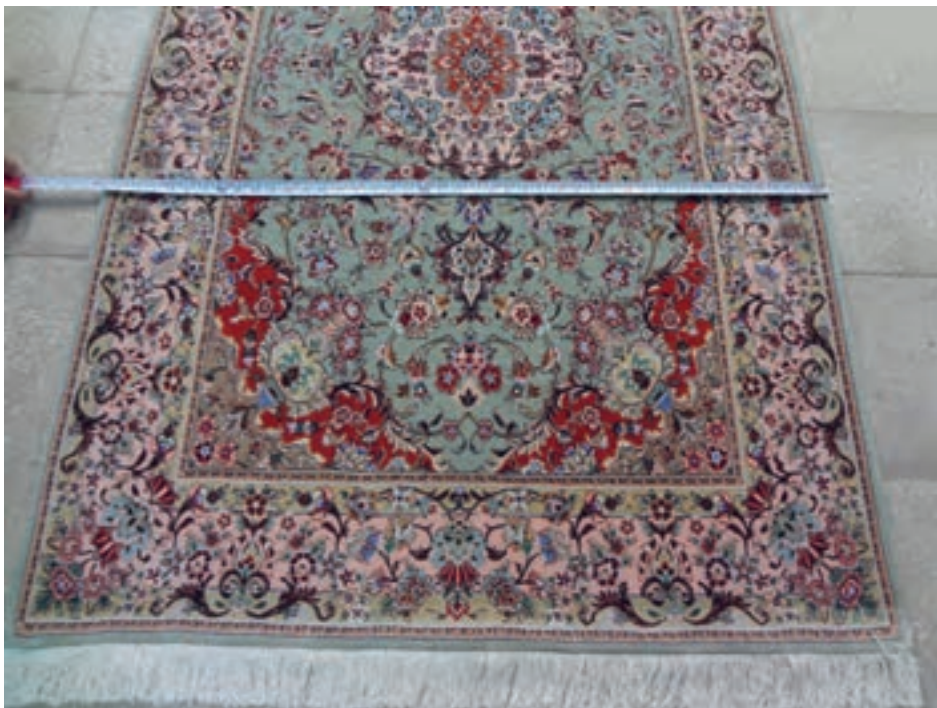
تصویر ۱۴- اندازه‌گیری عرض میانی قالی با متر ▲
