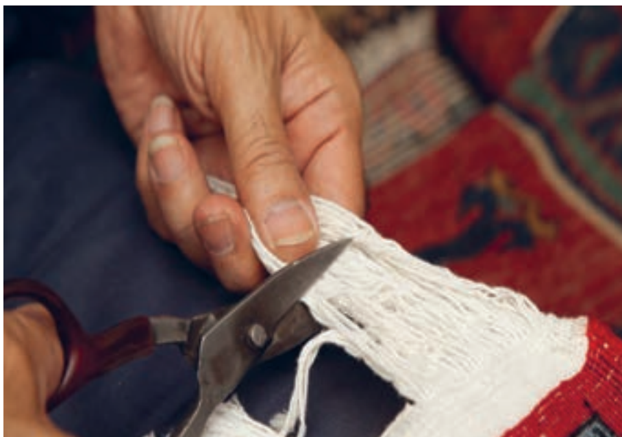
تصویر ۹- سر صافی و مرتب کردن ریشه ▲
