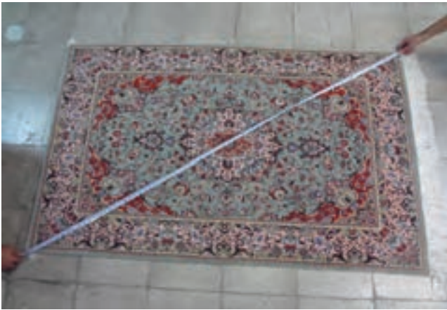
تصویر ۹- اندازه‌گیری قطرهای قالی با متر ▲
