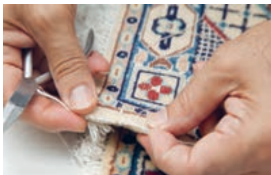
تصویر ۴۵ - تنظیم کشش نخ هنگام دوخت ▲
