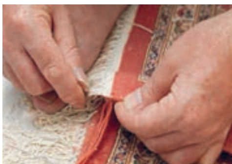
تصویر ۲۹- وارد کردن سوزن در رج بعدی ▲
