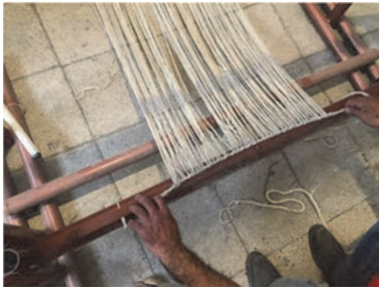
شکل ۴۱- بستن چله بر روی تیر پایین
