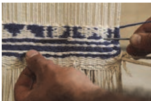
شكل ۷۵- قرار دادن سوزن مهيار در داخل بافته
