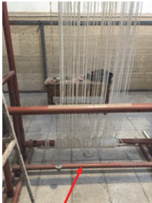
شکل ۴۴- تنظیم چله‌ها به کمک شاغول
