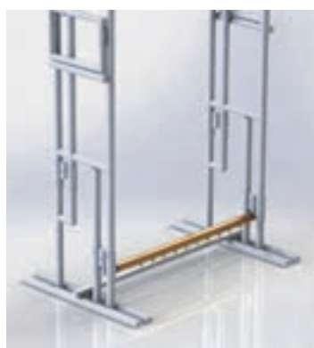
شکل ۵۸-قرار دادن تیر پایین
