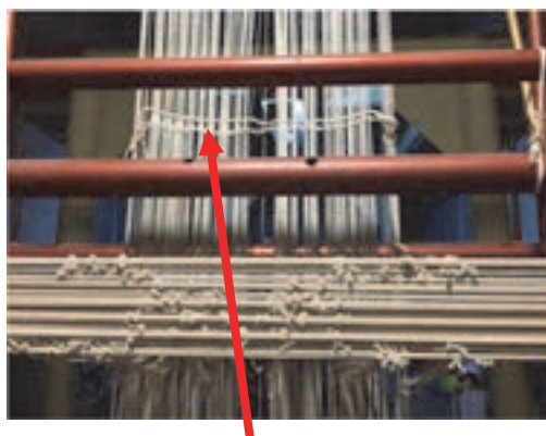
شکل ۶۴- قرار دادن نخ بچار لای چله‌ها
