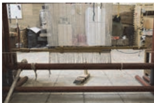
شكل ۷۷- مهيار پهناوند و بستن آن به كار
