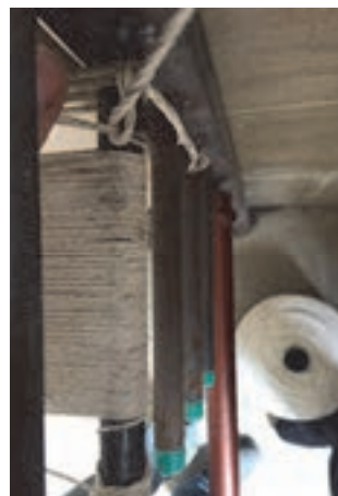
شکل ۳۳- عبوردادن نخ به صورت حلقه‌ای در سرکار شکل ۳۴- عبور دادن نخ به صورت زیگزاگ در ته کار
