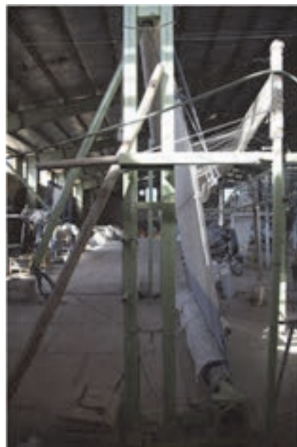
شکل ۴۸- دستگاه متحرک با اتصالات پیچ و مهره
