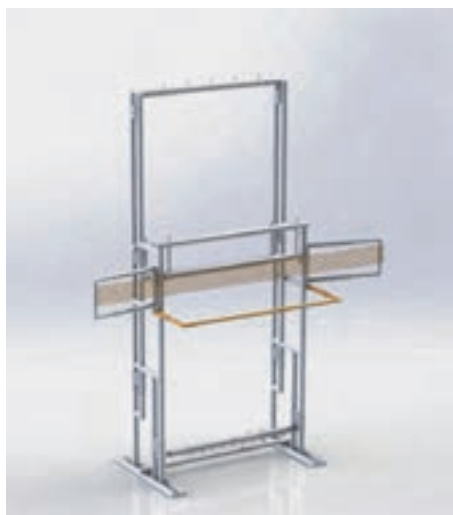
شکل ۶۵- قرار دادن میله پشت بند
