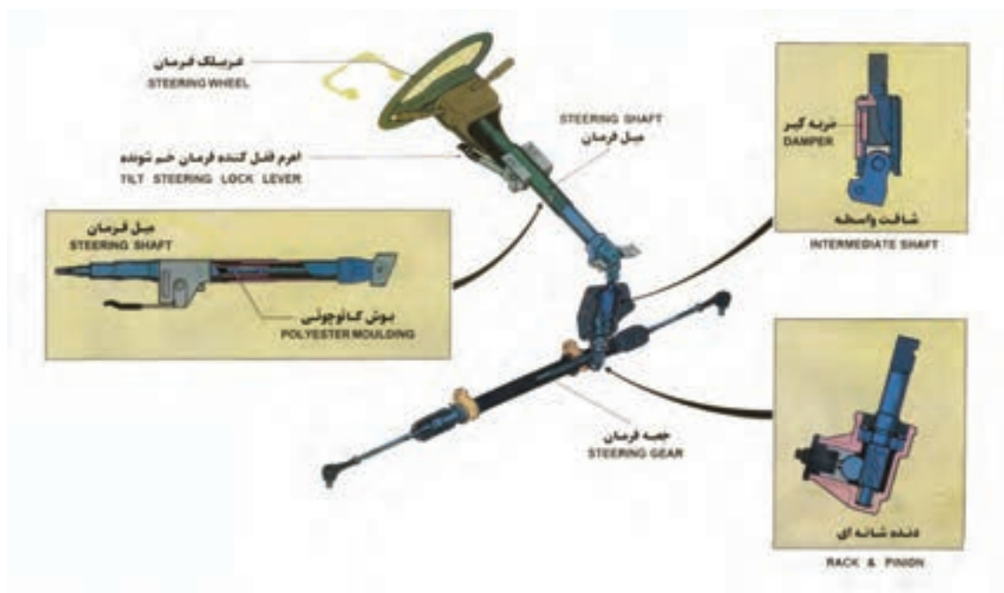
شکل ۲ - مجموعه فرمان و اجزای آن
