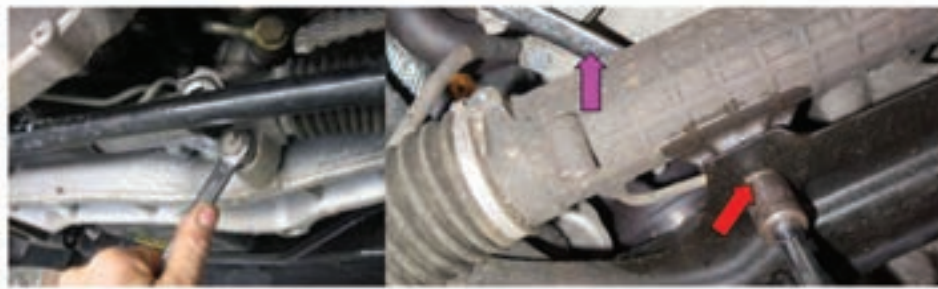
شکل ۲۰ - سفت کردن اتصالات جعبه فرمان
