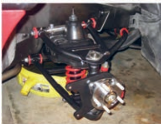
شکل ۳۹- مجموعه تعلیق طبق دار دوبل و روش تنظیم زوایا
