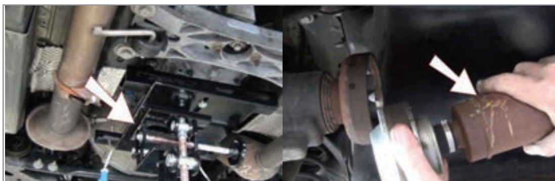
باز کردن گاردان و بستن ضربه‌گیر به گاردان
