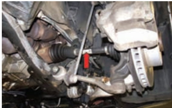
بررسی دسته نگهدارنده جعبه‌دنده
