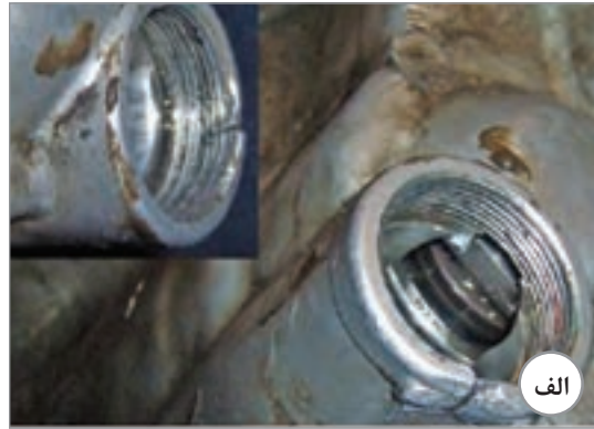
شکل ۲-۳۴- پوسته جعبه‌دنده و نحوه ترمیم آن
