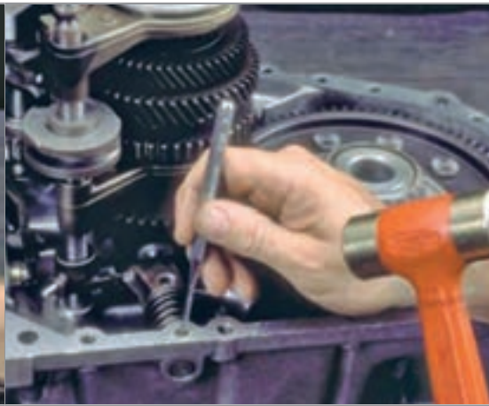
خارج کردن پین نگهدارنده اهرم تعویض دنده
