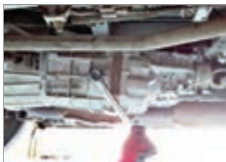
شکل ۲-۲۳- پر کردن روغن جعبه دنده
