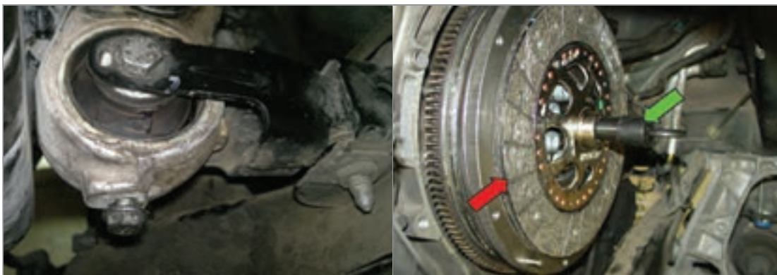
بررسی دسته نگهدارنده جعبه‌دنده
