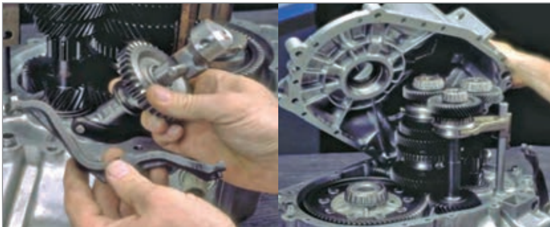
باز کردن پوسته جعبه‌دنده
