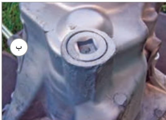
شکل ۲-۳۴- پوسته جعبه‌دنده و نحوه ترمیم آن
