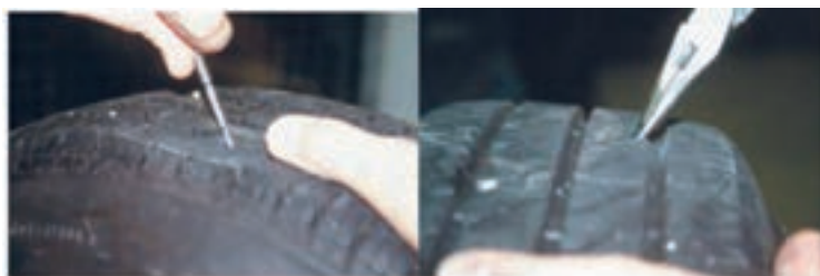
شکل ۲۲- روش بررسی و خارج کردن جسم خارجی از تایلر
