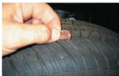
شکل ۱۷- نحوه اندازه‌گیری تقریبی شیار تایر
