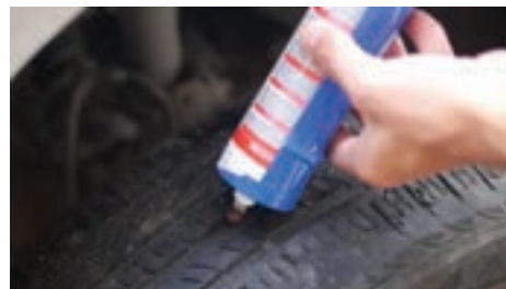
شکل ۲۷- مراحل پنچرگیری تایر بدون تیوب
