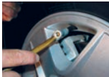
استفاده از ابزار گیج فشار مناسب
