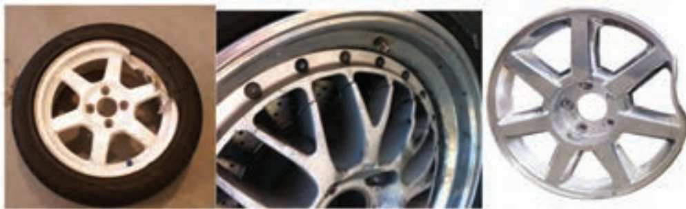
شکل ۳۵- بررسی ظاهری رینگ
