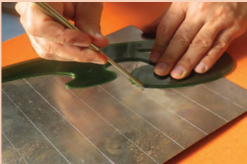
شکل ۳۴-۱- خط کشی ورق فلزی با پیستوله
