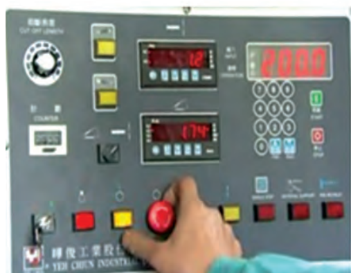
شکل ۹-۱- نمایی از صفحه تنظیمات در گیوتین CNC
