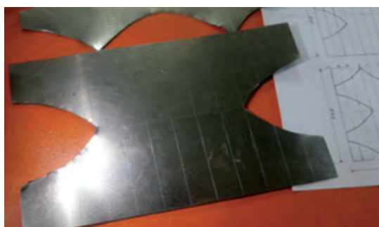
شکل ۱-۴۲- پلیسه‌های ایجاد شده در لبه‌های برش
