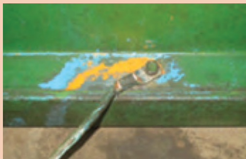
شکل ۱-۲۳- نمونه‌ای از سیم ارت در گیوتین
