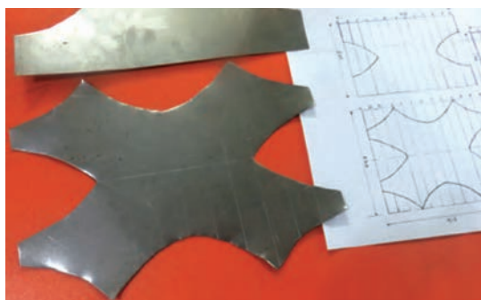
شکل ۱-۴۳- کنترل برش نهایی مطابق با نقشه
