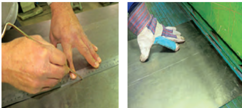
شکل ۱-۱۴- خط‌کشی و برش‌کاری ورق فولادی با گیوتین
