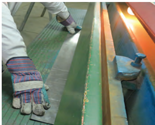
شکل ۷-۱- تنظیم خط برش با چشم توسط اپراتور
