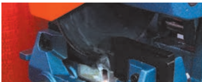
شکل ۱-۱۹- برشکاری با اره آب صابونی
