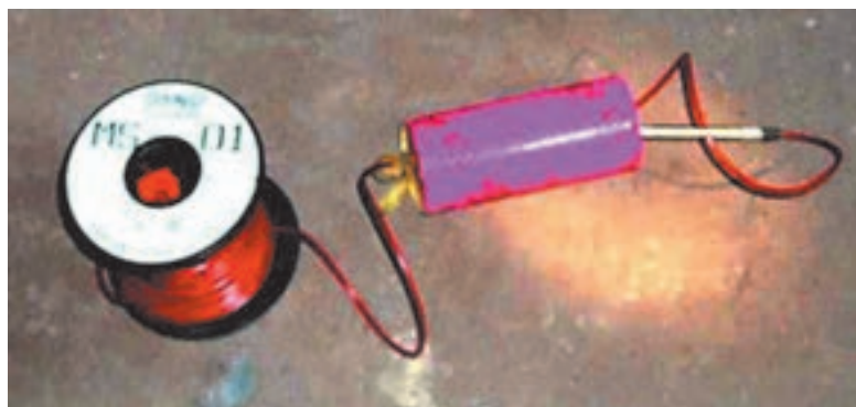
طریقه قرار دادن چاشنی درون دینامیت
