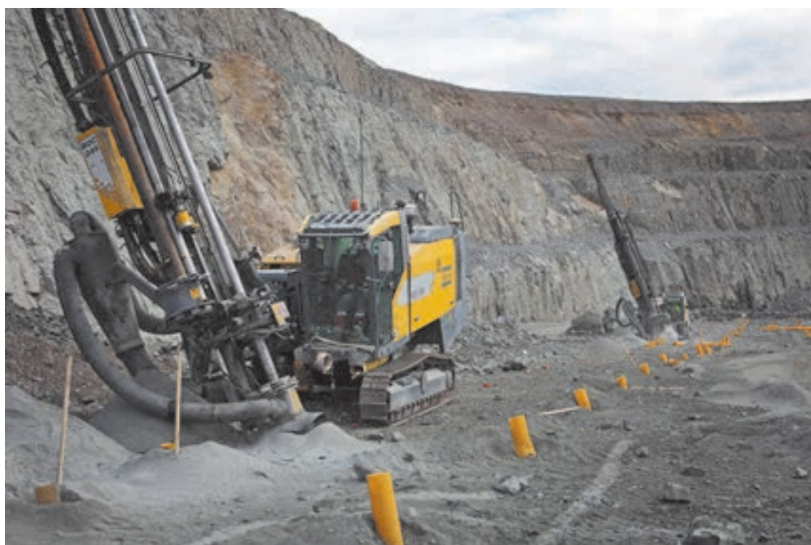
قراردادن لوله‌های پلی اتیلن در چال‌ها جهت جلوگیری از ریزش مواد در چال
