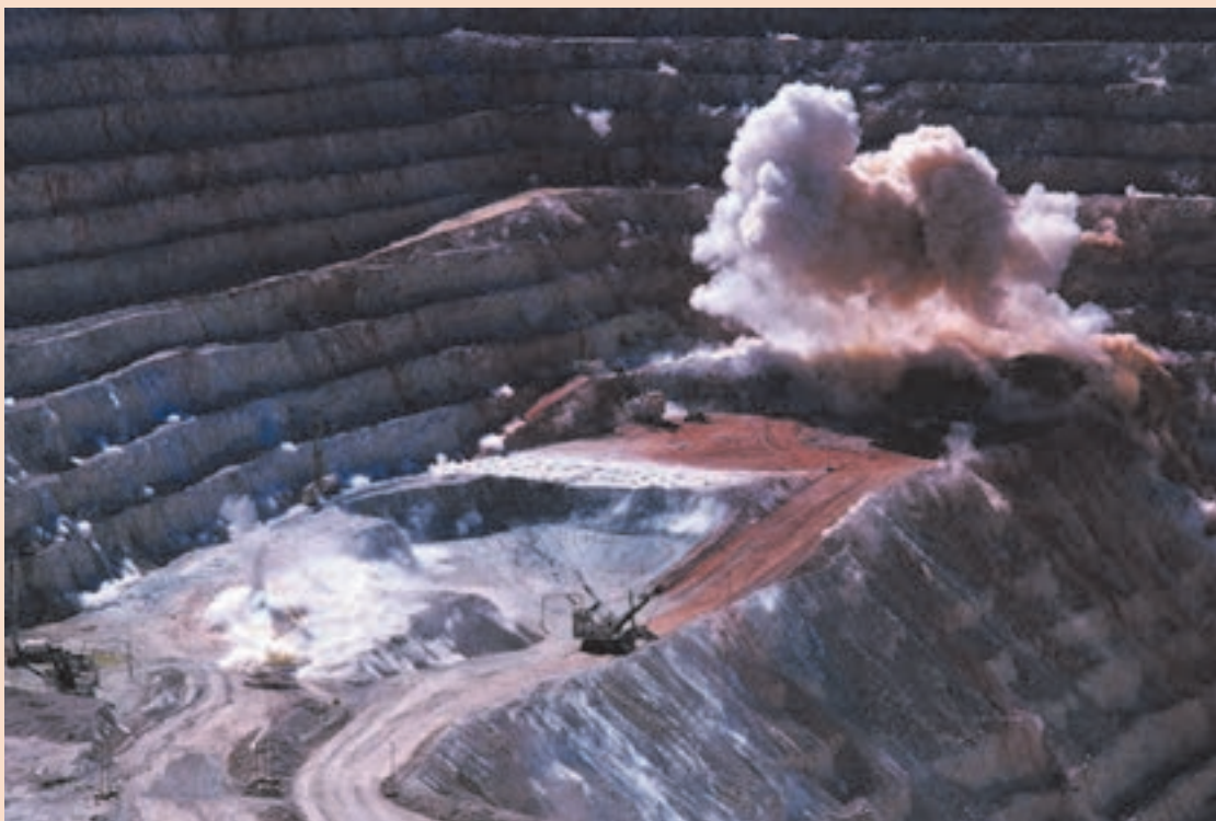
عملیات چال‌زنی و آتشیاری در معدن
