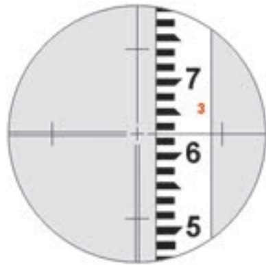
تارهای رتیکول داخل دوربین نقشه برداری
