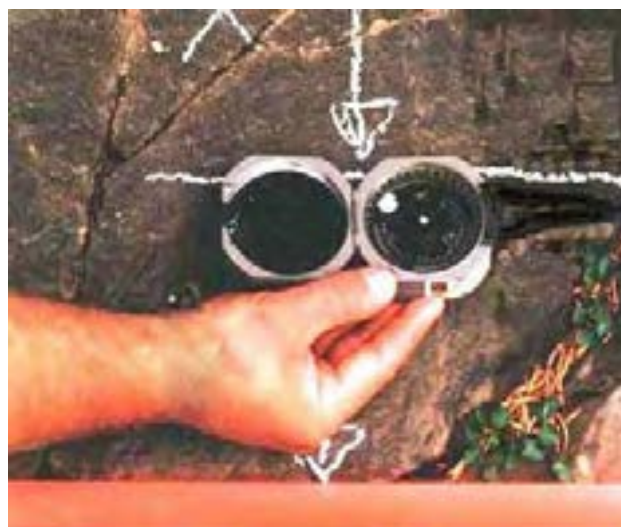
طریقه قرار دادن لبه کمپاس بر روی لایه برای به دست آوردن امتداد لایه
