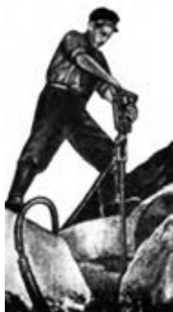
شکل ۴-۱۳- وضعیت ناپایدار کارگر کوه‌بُر بر روی گرانیت (۶)
