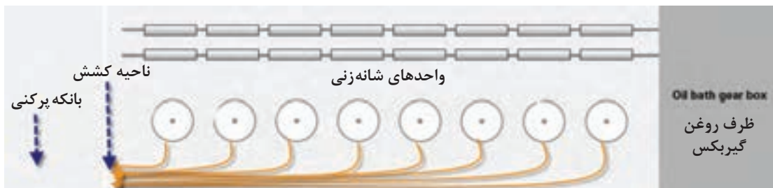
شکل ۴۲- نحوه تولیدگیری در ماشین شانه
