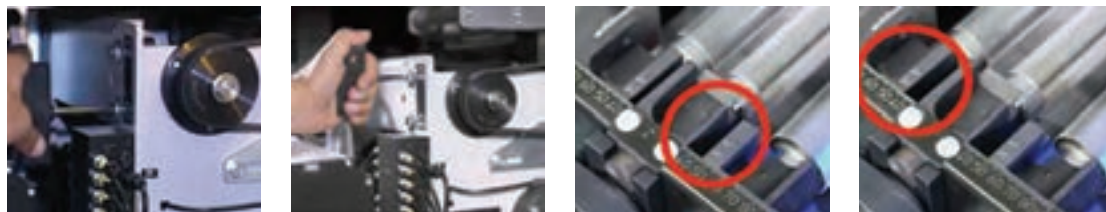
شکل ۹- تنظیم فاصله نواحی کشش بین غلتک‌ها
