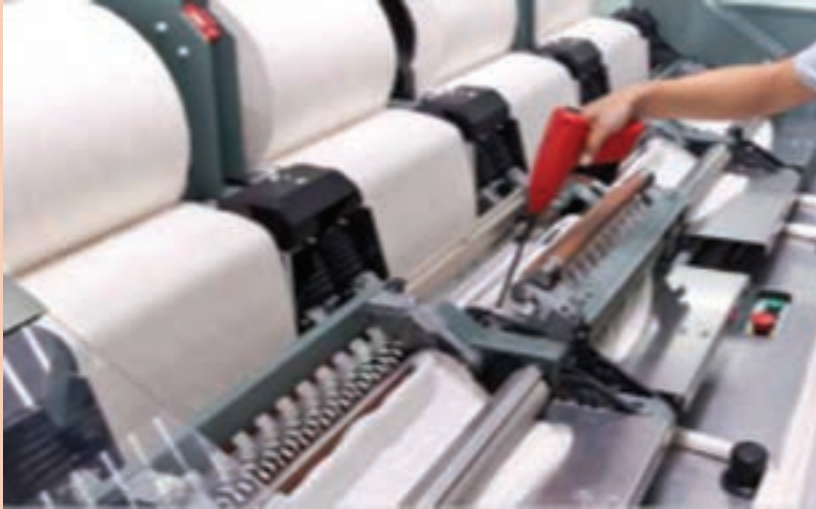
شکل ۴۳- روش پرزگیری با تفنگی پرزگیر
