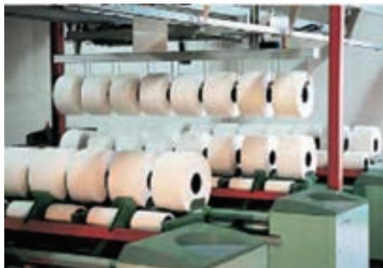
شکل ۲۸- نحوه قرارگیری بالشچه‌ها روی دستگاه شانه
