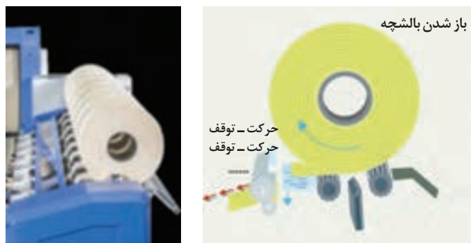
شکل ۳۲- بخش باز شدن لایه بالشچه یا تغذیه
