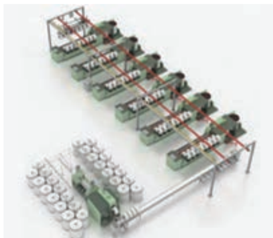
شکل ۲۷- روش انتقال اتوماتیک بالشچه
