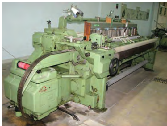
شکل ۱۷- ماشین بافندگی با پودگذاری راپیر
