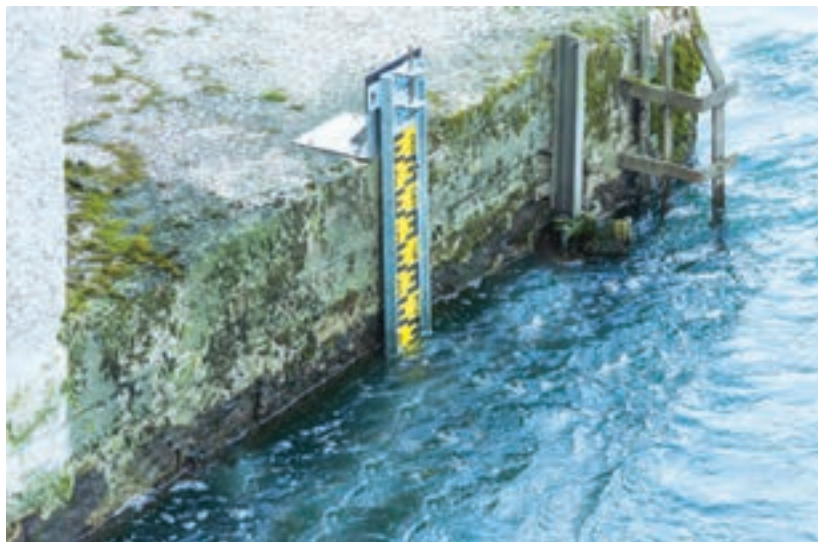
شکل ۱- نمایی از یک سطح‌سنج برای سنجش ارتفاع سطح آب
