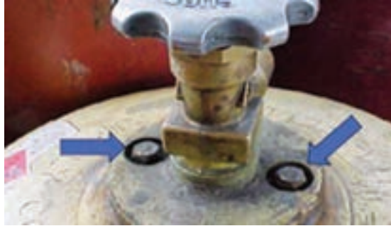
شکل ۳۳- مجرای ذوب شدنی روی شانه یک سیلندر گاز تحت فشار و یک مجرای ذوب شدنی مجزا قبل از نصب
