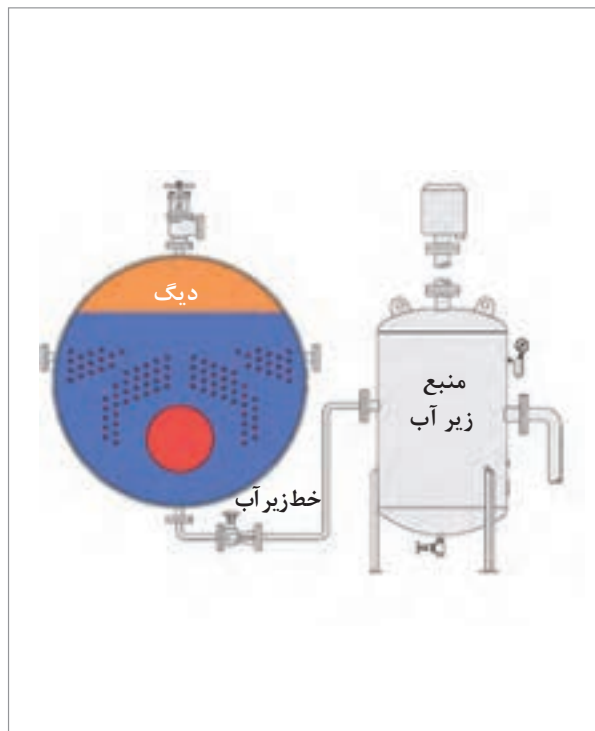
شکل ۹- نمایش جریان دوریز دیگ بخار (زیر آب یا بلودان)
