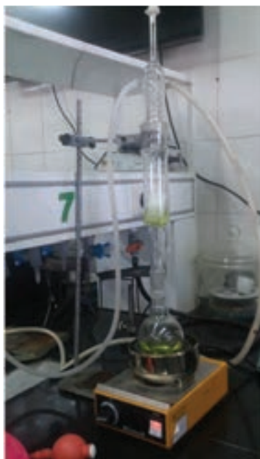
شکل ۱۷-۵- شمای ساده‌ای از سوکسله
