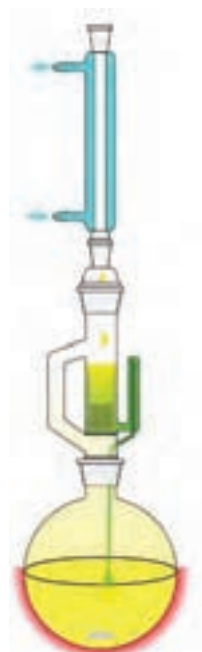
شکل ۱۷-۵- شمای ساده‌ای از سوکسله
