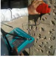
شکل ۹. دستگاه تست بتن
