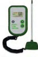
شکل ۸. دستگاه اندازه‌گیری PH حاصلخیزی و دمای خاک
