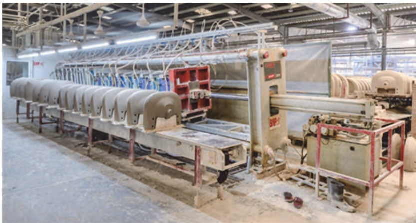
شکل ۶- ریخته‌گری دوغابی با فشار پایین
