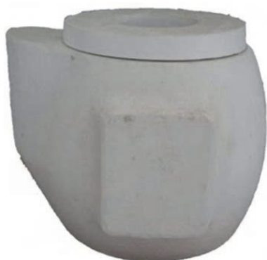
شکل ۲۷- قالب قوری درزبندی شده
