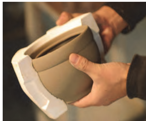
الف- خارج کردن بدنه ریخته‌گری شده
