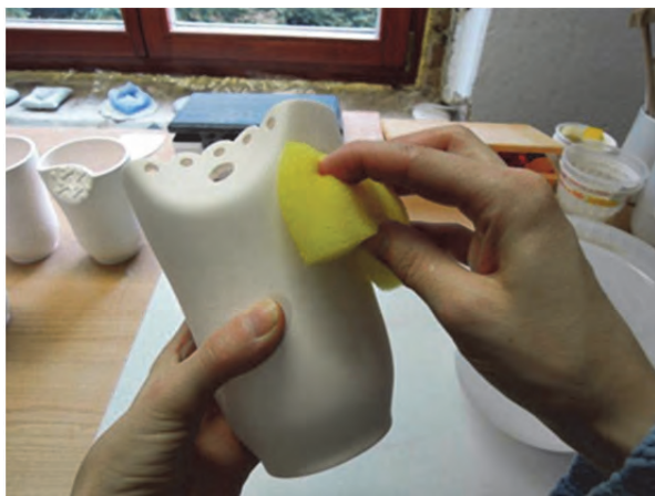
شکل ۳۱- پرداخت بدنه‌های ریخته‌گری دوغابی
