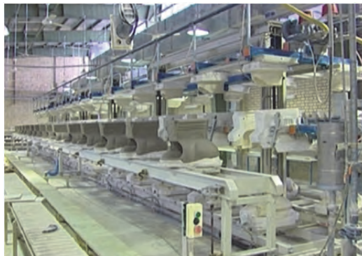
شکل ۳۷- بیرون آوردن بدنه از قالب
