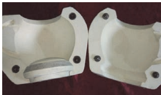
شکل ۲۴- الگوی گچی با زبانه‌های پلاستیکی
