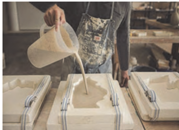
الف) ریخته‌گری دوغابی به روش دستی
