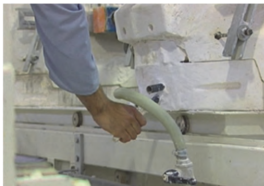
شکل ۳۵- باز کردن لوله‌ها جهت تخلیه دوغاب اضافی
