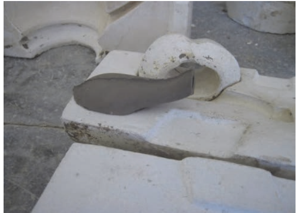
شکل ۴۲- شکل‌دهی جداگانه لوله و بدنه قوری
