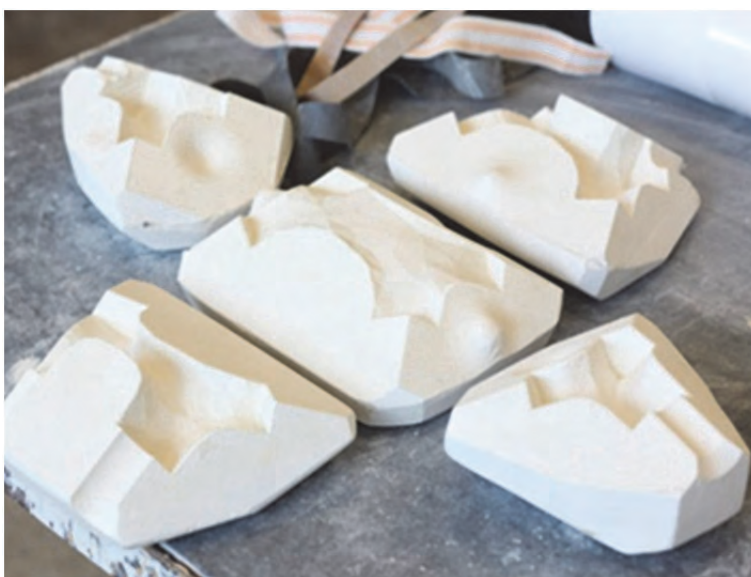
شکل ۴۸- قالب با زاویه‌های متعدد
