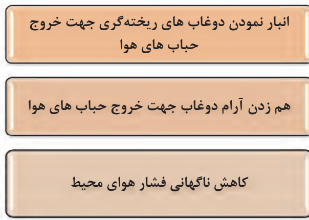
نمودار ۳- روش‌های برطرف کردن عیب سوراخ سنجاقی
