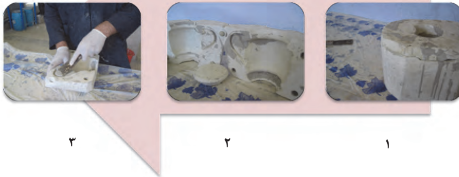
شکل ۵- بررسی قالب و جدا کردن لایه‌های دوغاب خشک شده از آن
