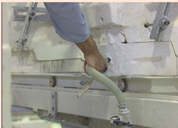
شکل ۲۵- مجرای زیر قالب جهت تخلیه دوغاب
