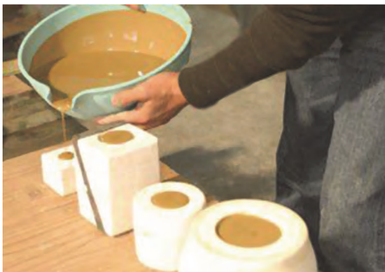
شکل ۴۷- پر کردن قالب با سرعت مناسب
