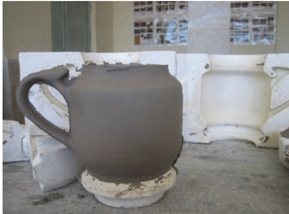
شکل ۴۲- شکل‌دهی جداگانه لوله و بدنه قوری
