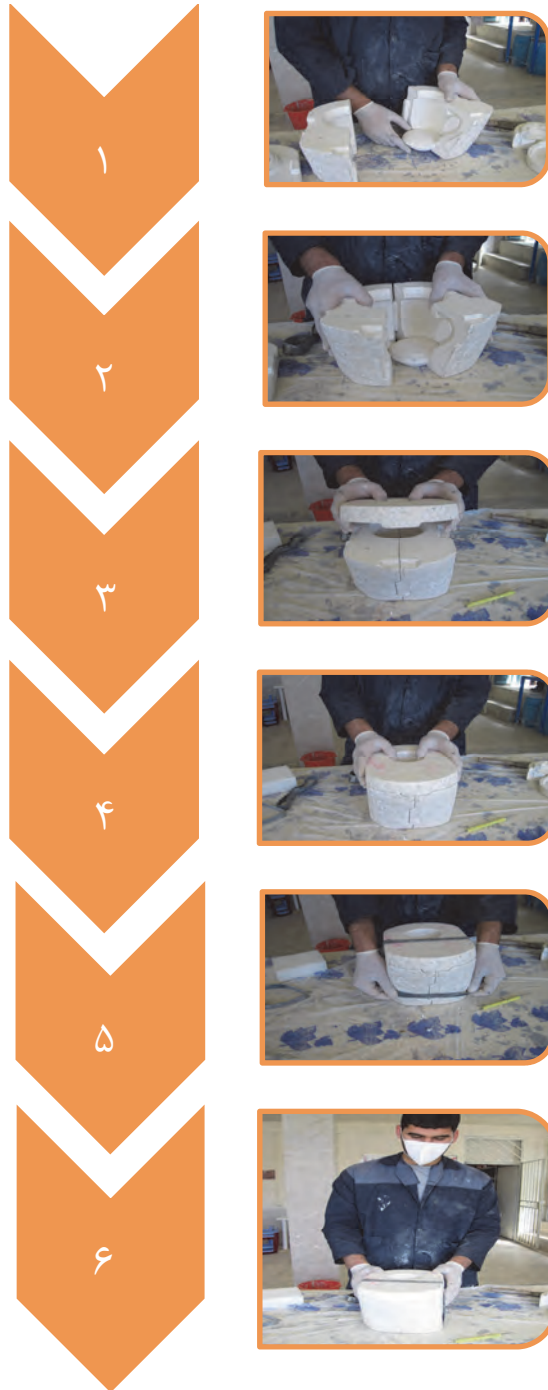
شکل ۷- مراحل بستن قالب
