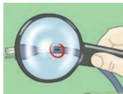
الف) پارگی پوشش سیم تغذیه
