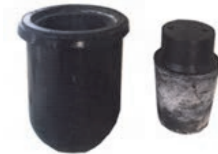
شکل ۱۴- قالب و پانچ پلی یورتانی جهت تولید گلوله
