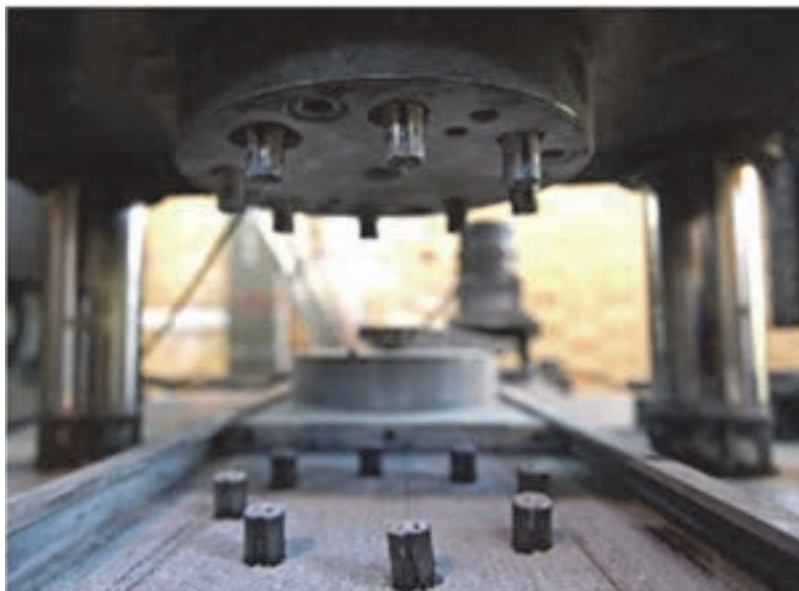
شکل ۱۱- پرس با قالب حاوی ۸ حفره
