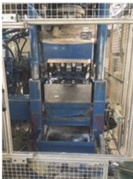
شکل ۱۳- پرس ایزواستاتیک گلوله آلومینایی
