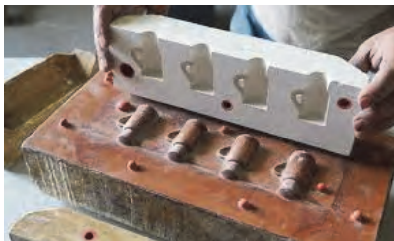
شکل ۴- قالب گچی با قابلیت ریخته‌گری چهار قطعه
