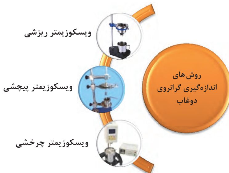
شکل ۷- روش‌های اندازه‌گیری گرانروی دوغاب
