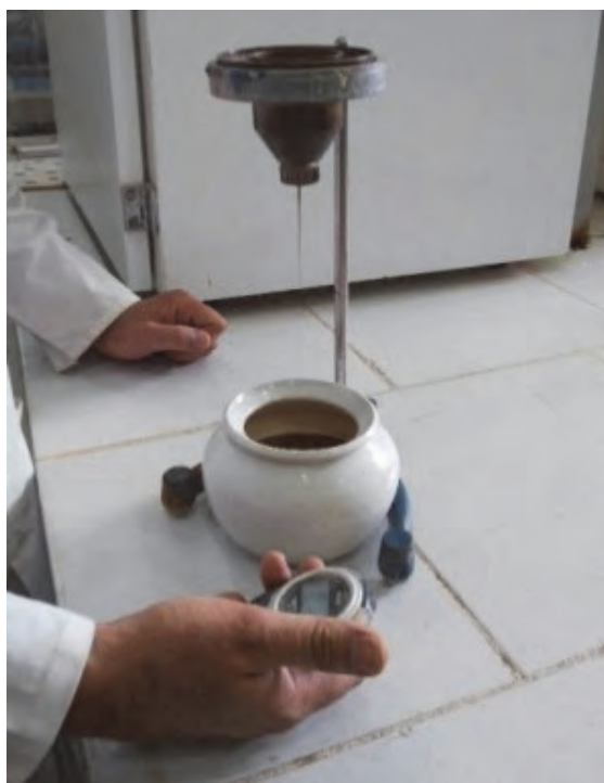
شکل ۱۶- اندازه‌گیری گرانروی دوغاب
