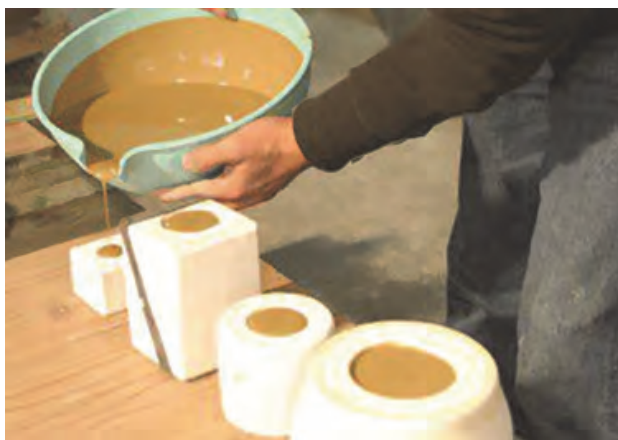
شکل ۱۳- دوغاب مناسب ریخته‌گری دوغابی
