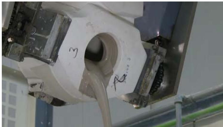
شکل ۲۲- دوغاب هنگام ریخته‌گری
