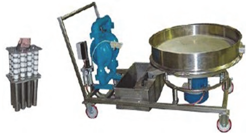
شکل ۲۶- گاری الک، آهن‌ربا و پمپ
