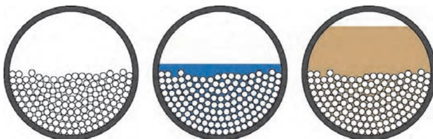
شکل ۱۷- محتویات فضای داخلی بال‌میل
