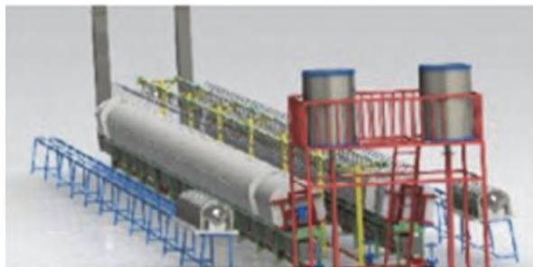
ب) قرار دادن مخزن دوغاب در ارتفاع
