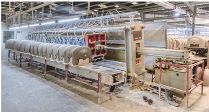
شکل ۶- ریخته‌گری دوغابی با فشار پایین
