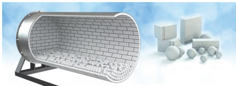
شکل ۱۹- جداره داخلی بال‌میل از جنس آلومینا
