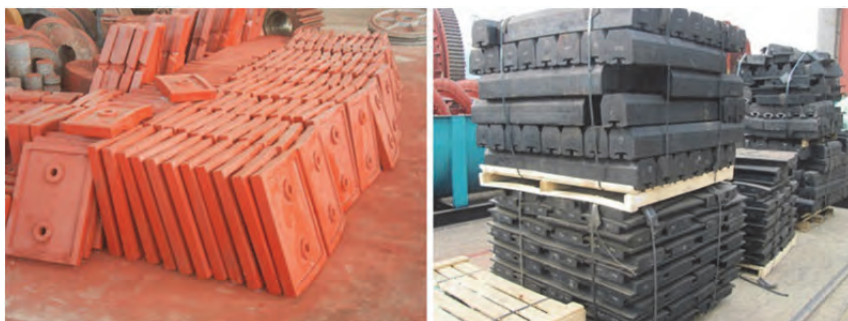
شکل ۲۱- آستر لاستیکی بال میل
