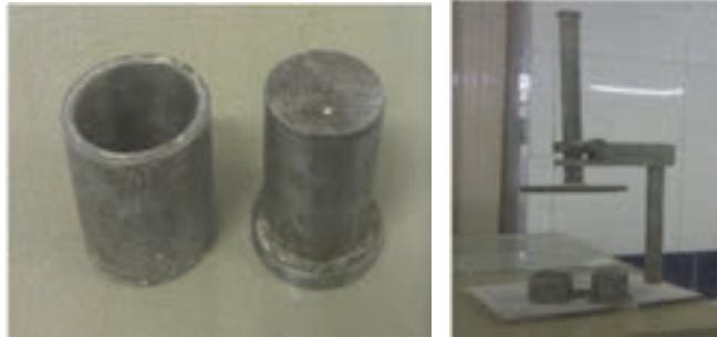
شکل ۱۶- دستگاه ففرکورن و قالب نمونه‌ساز
