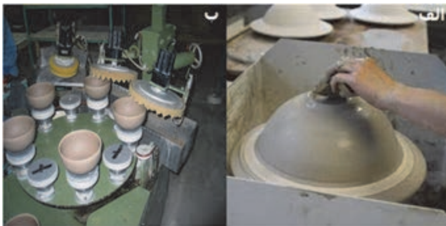
شکل ۱۸- پرداخت نمونه به روش (الف) دستی - (ب) اتوماتیک
