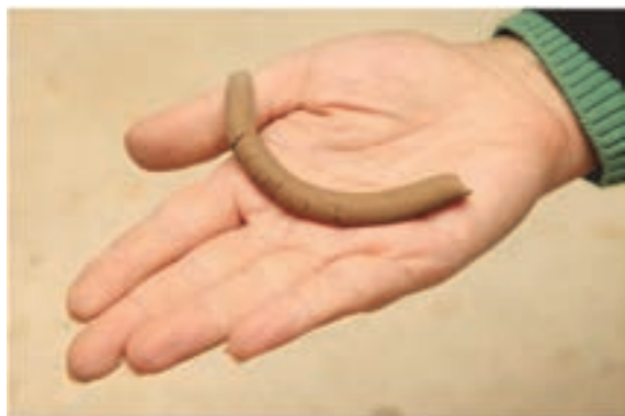
شکل ۱۴- بررسی فتیله در روش آتربرگ
