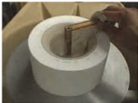
شکل ۳۵- پایین آوردن بازوی جولی و شکل‌دهی
