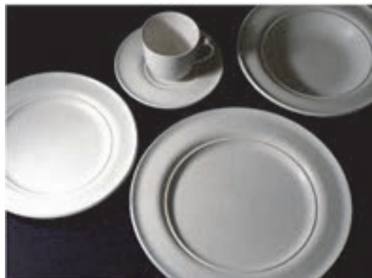
شکل ۳- قطعات تولیدشده به روش جیگر و جولی
