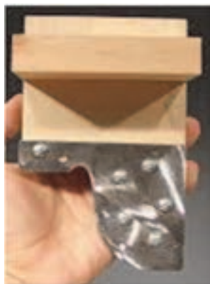
شکل ۱۴- شابلون تقویت شده با چوب
