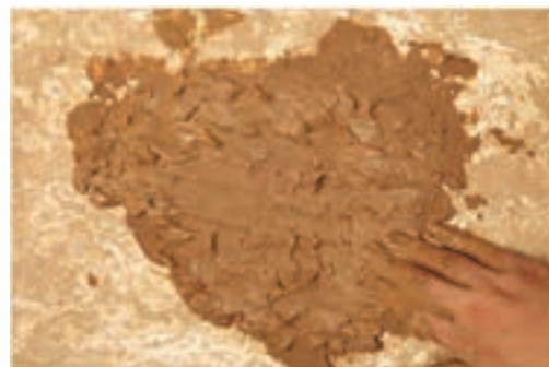
شکل ۱۰- تهیه گل یکنواخت با دوغاب
