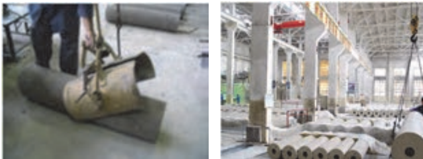
شکل ۲۲- جابه‌جایی شمش‌ها به کمک جرثقیل
