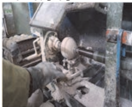
شکل ۵- شکل‌دهی قطعات سرامیکی به روش تراش
