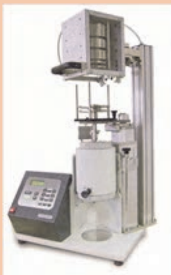
شکل ۳۰- دستگاه پلاستومتر و اجزای آن
