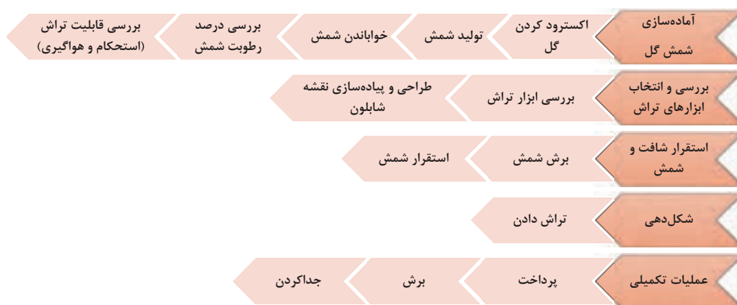
شکل ۷- مراحل شکل‌دهی گل پلاستیک به روش تراش
