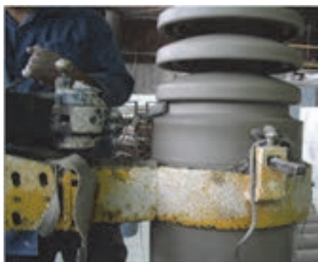
شکل ۵- شکل‌دهی قطعات سرامیکی به روش تراش
