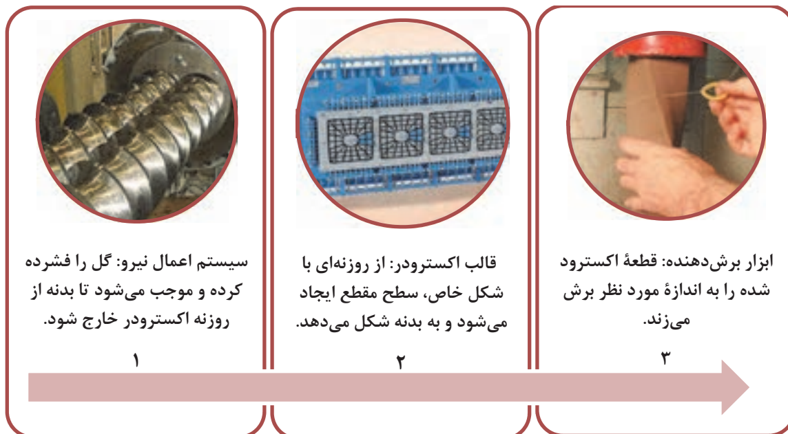
شکل ۵- اجزای ماشین اکسترودر
