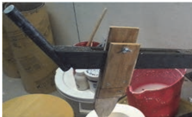
شکل ۱۵- شابلون چوبی و پلاستیکی تقویت شده با چوب
