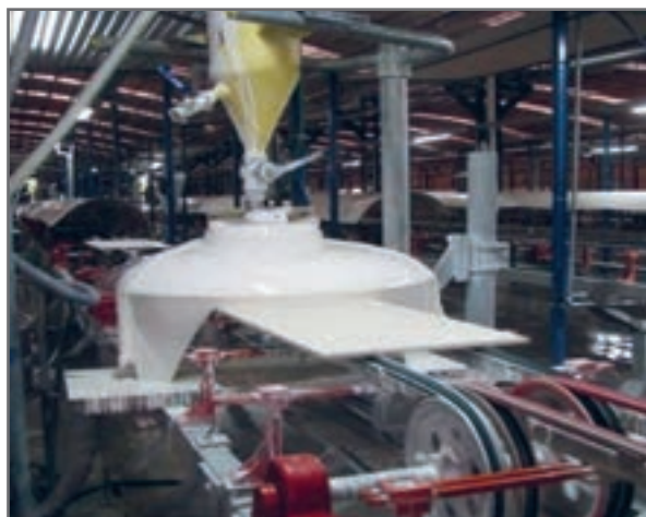
شکل ۲۳- لعاب‌زنی به روش آبشاری
