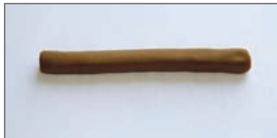
گل با شکل‌پذیری مناسب - بدون ترک
