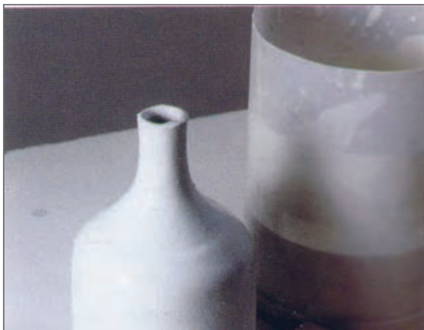
شکل ۱۸- قطعه لعاب زده شده به روش غوطه‌وری
