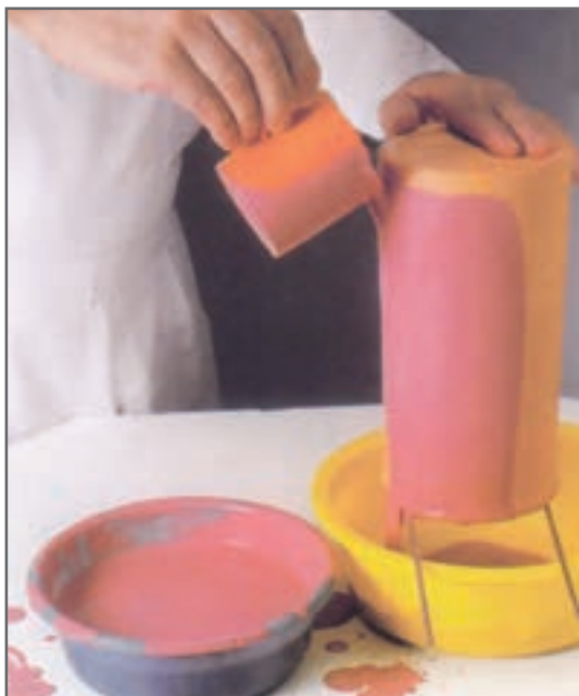
شکل ۱۴- اعمال لعاب به روش ریختنی
