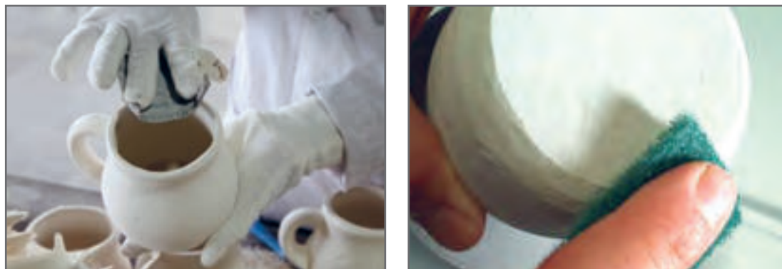
شکل ۹ - پرداخت خشک قطعه با اسکاچ و سنباده
