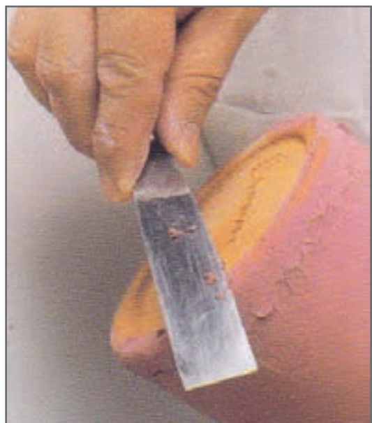
شکل ۱۵- پاک کردن کف قطعه از لعاب
