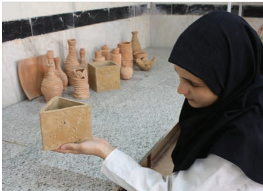
شکل ۱۳- کنترل چشمی فرآورده‌های سرامیکی تولید شده به روش دستی
