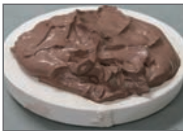
الف - گل پخش شده روی سطح گچ
