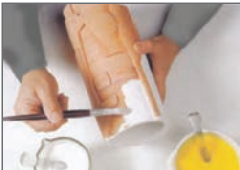
شکل ۱۱- اعمال لعاب بر روی سطح بیرونی قطعه
