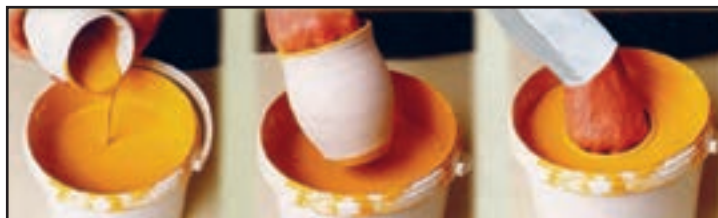
شکل ۱۹- لعاب‌زنی دستی و کارگاهی
