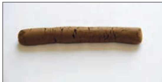
گل با شکل‌پذیری نامناسب - دارای ترک
