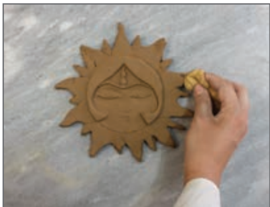
شکل ۷- پرداخت محصولات سرامیکی با ابزارهای مختلف
