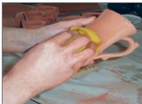
شکل ۴- حذف گرد و غبار از سطح سرامیک با استفاده از اسفنج مرطوب جهت اعمال لعاب
