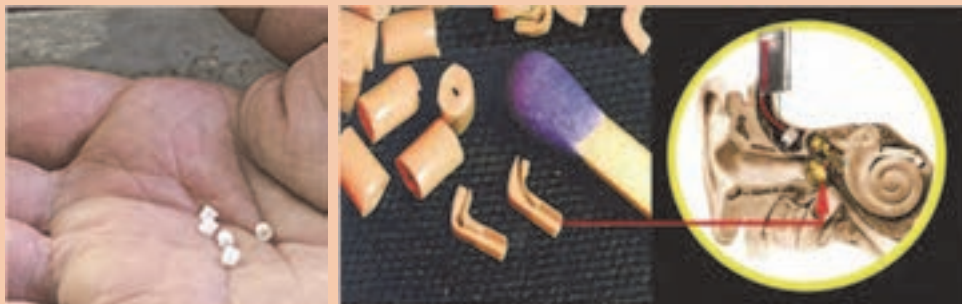
شکل ۱۳- میکروسازه‌ای به وزن ۰/۰۰۲۲ گرم مورد استفاده در سمعک
