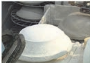
شکل ۲۷- قرار دادن قالب بر روی زبانه
