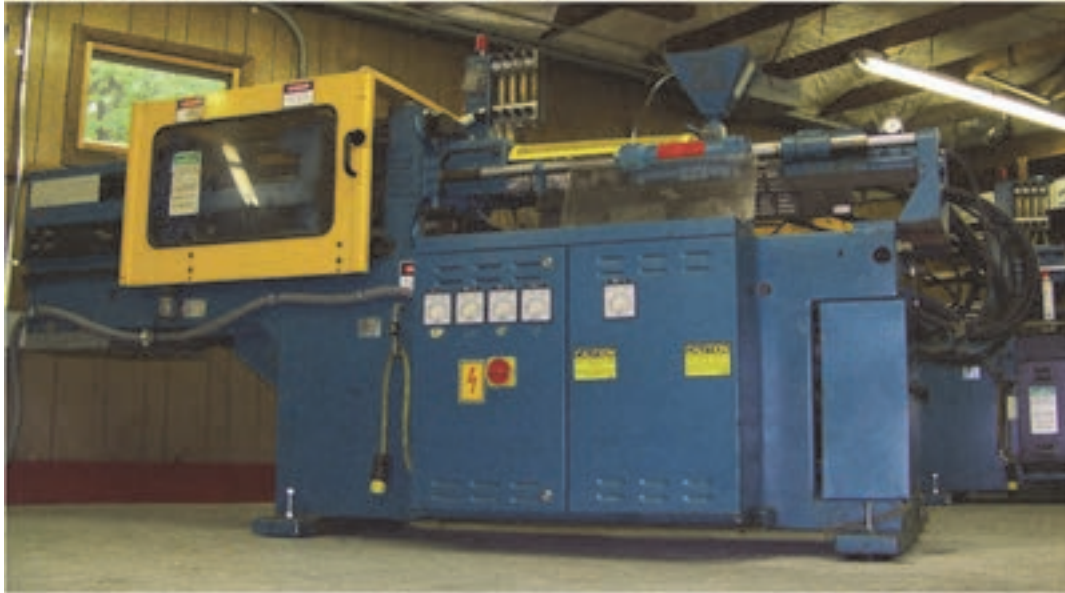
شکل ۱۷- دستگاه قالب‌گیری تزریقی
