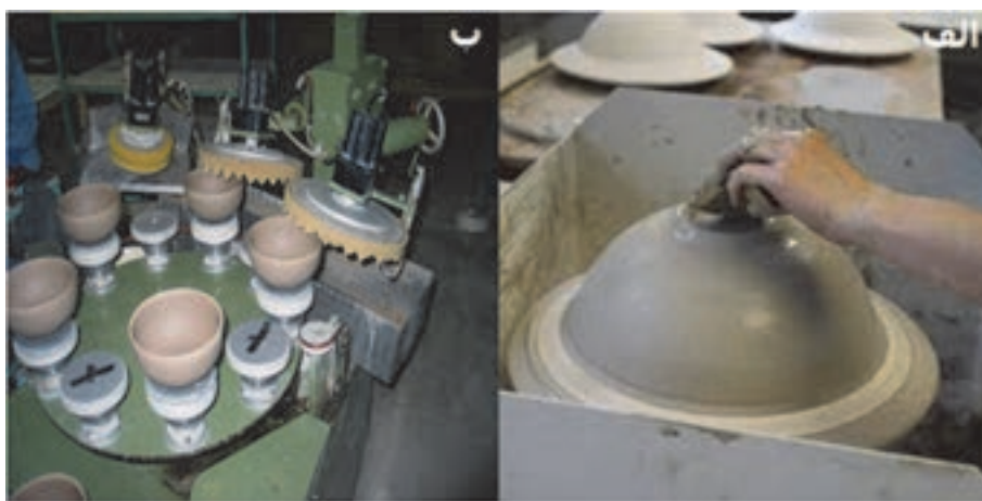
شکل ۱۸- پرداخت نمونه به روش (الف) دستی - (ب) اتوماتیک
