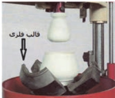
شکل ۹- قالب فلزی چند تکه مورد استفاده در روش جیگر و جولی
