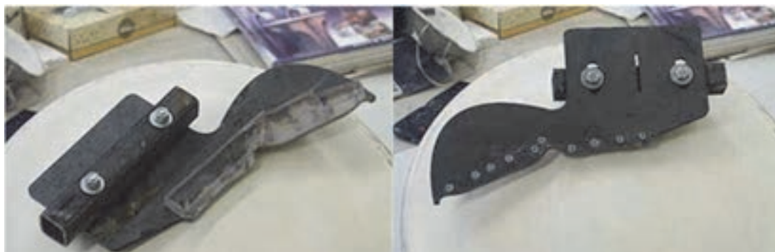
شکل ۱۶- شابلون با پیچ و مهره قابل تنظیم
