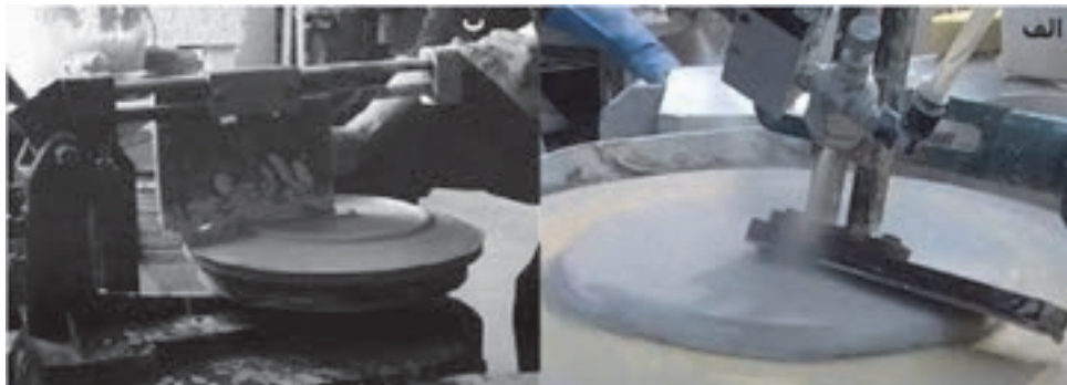
شکل ۲۸- الف) پهن کردن گل، ب) شکل دادن
