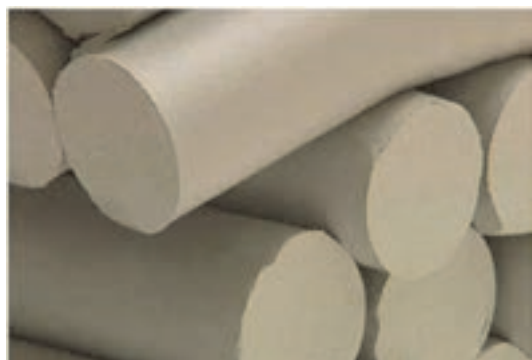
شکل ۵- اکستروود کردن گل پلاستیک
