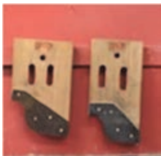
شکل ۱۳- شابلون مورد استفاده در شکل‌دهی با استفاده از روش جولی
