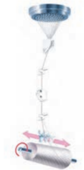
شکل ۲- قطعات سرامیکی مورد استفاده در تاباندن نخ
