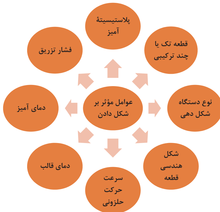
نمودار ۴- عوامل مؤثر بر شکل‌دهی در روش قالب‌گیری تزریقی
