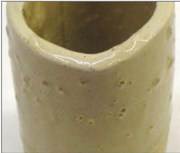
شکل ۳۴- عیب تاول زدن لعاب
